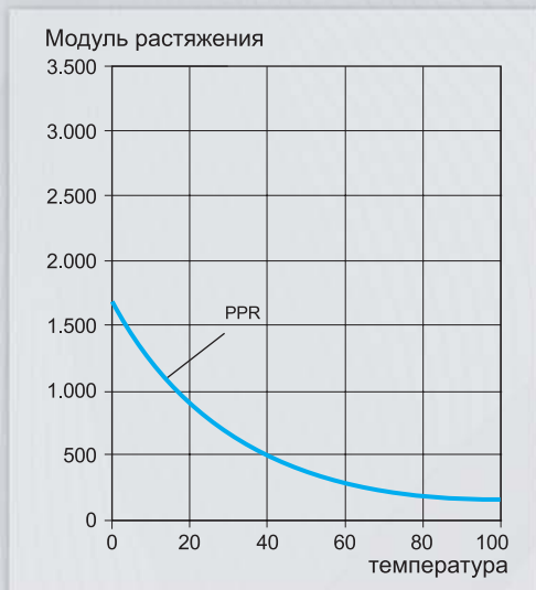
График 4. Модуль упругости при растяжении как функция температуры для PP-R (измеренная посредством теста растяжения в соответствии с ISO 527, тест баг тип 1A, метод прессования )
