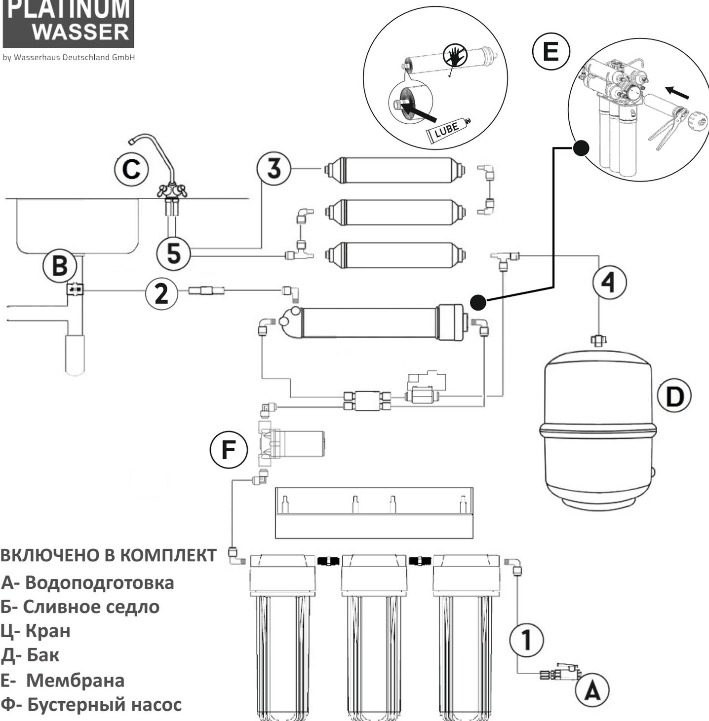
Патчи фильтра внутри коробки отсоединяются в местах, помеченных цифрами 1,2,3,4,5. Соберите фильтр, используя трубку 1/4 дюйма.
